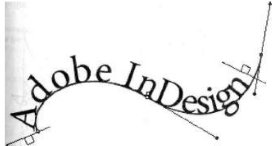
Рис.2.28. Текстовый фрейм, набранный вдоль контура, у которого, как и любого другого фрейма, есть маркеры входа и выхода (квадратики по краям)
